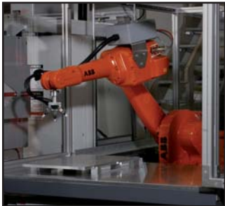
Be-/Entladen HAAS Mini Mill
